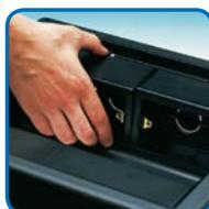
La torretta a scomparsa NEST è fornita completa di supporti porta apparecchi di tipo universale, idonei ad alloggiare telai a 4 moduli (interasse 108 mm) riconducibili a 3 moduli (interasse 83,5 mm) utilizzando il riduttore fornito in dotazione. Il montaggio dei supporti è a scatto.
